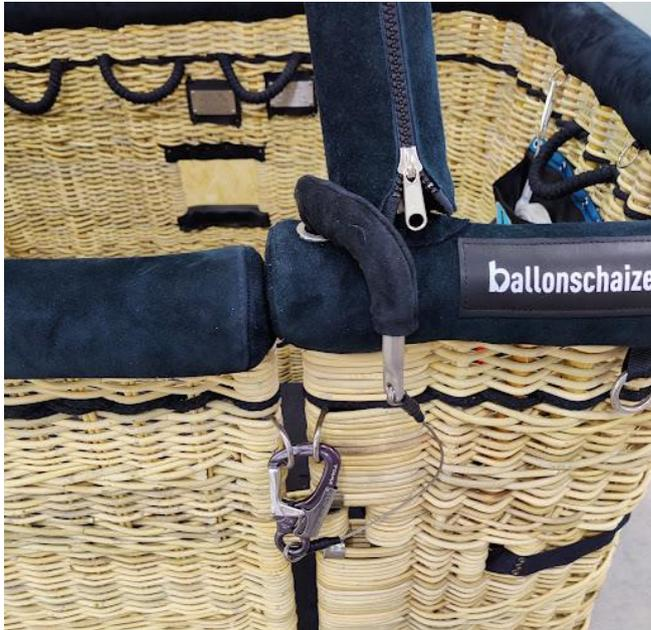
Porte fermée, la barre verticale est insérée entièrement et le mousqueton est attaché à la porte et à la nacelle.
